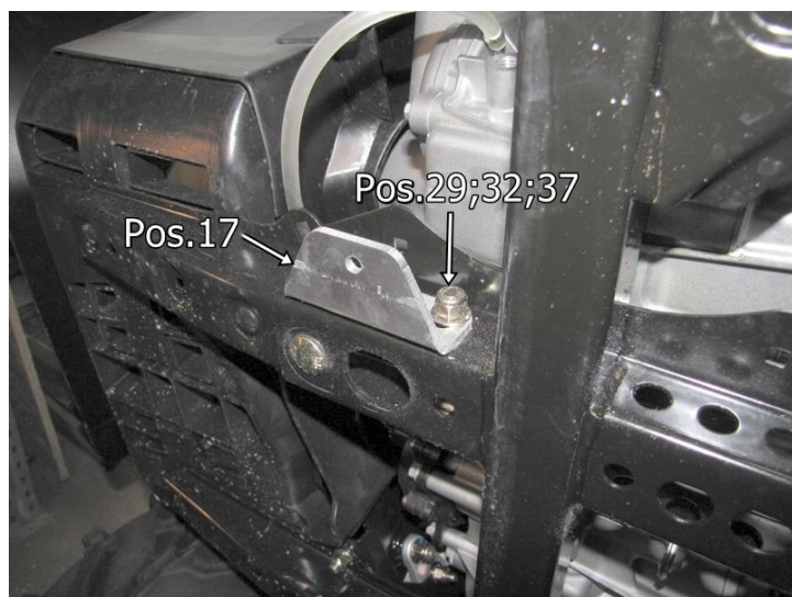
Samm 3 Paigalda põhjakaitsme kesmine osa 02.8401K.
